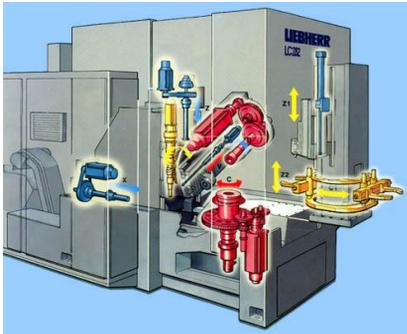
Jede Werkzeugmaschine wird als „Kinematische Kette“, bestehend aus Dreh- und Schubgelenken dargestellt.
